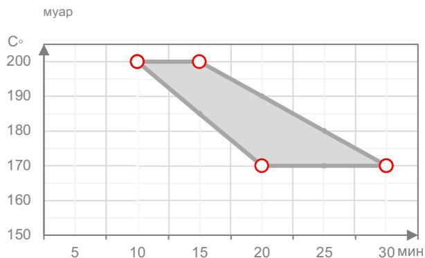
Пожалуйста, внимательно следите за параметрами отверждения, т.к. механические свойства проявляются при полном отверждении.
